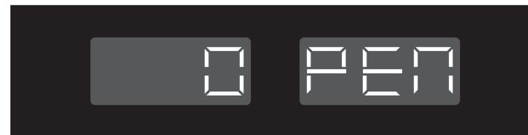
“OPEN”门没关好：蒸烤一体机工作过程中没关好门，请将门关好。
