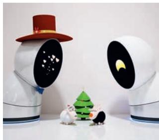
奥叮可以像人一样具有自我学习的能力，能在复杂环境下实现毫秒级识别精度，认识和记住你。基于大数据情感计算引擎，可以和你进行个性化自然交流。可以连接智能设备，实现远程控制，800 万像素高清摄像头、360 度方位识别……是可以 24 小时全天候保障家居安全、设置智能化场景的超级机器人。
